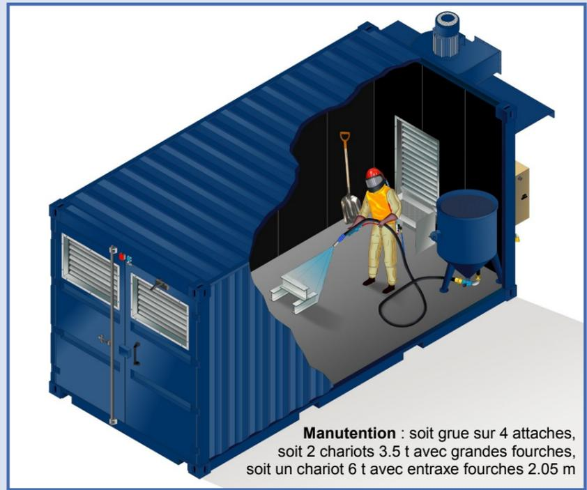
**Manutention :** soit grue sur 4 attaches, soit 2 chariots 3.5 t avec grandes fourches, soit un chariot 6 t avec entraxe fourches 2.05 m
